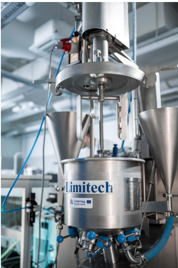
Joonis 7. Taimsete piimaanalooide valmistamiseks kasutatud 10-liitrine katel tooraine segamiseks, kuumutamiseks ning fermentatsiooni teostamiseks
