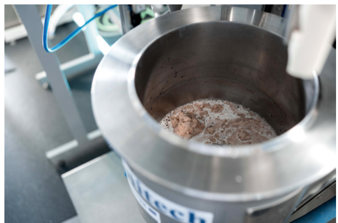
Joonis 7. Taimsete piimaanalooide valmistamiseks kasutatud 10-liitrine katel tooraine segamiseks, kuumutamiseks ning fermentatsiooni teostamiseks
